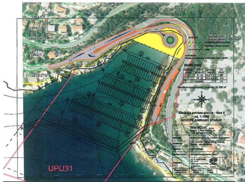
Luka Muroskva- izgradnja lukobrana i gatova ( koncesija)
